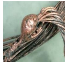
火災で発生する電気溶融痕の例
