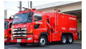
海水利用型消防水利システム(スーパーポンパー)
