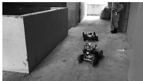
図5 中継ロボットによる通信ケーブル敷設
