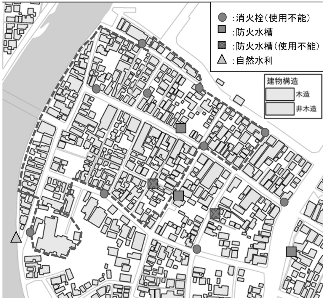
図1 輪島市大規模火災とその周辺の消防水利 ※点線内が焼失範囲 文献3)より作成
