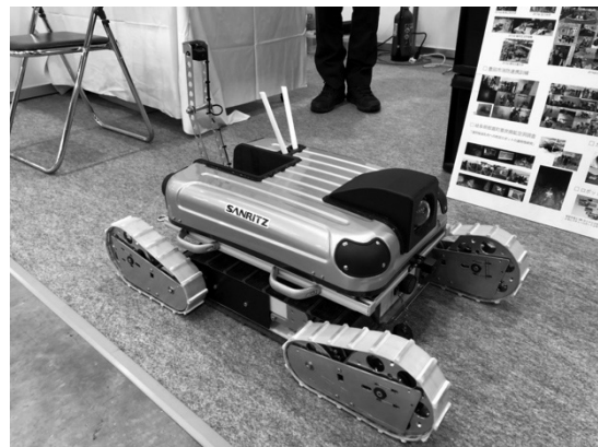
図2 監視点検用クローラロボット ARTHUR
